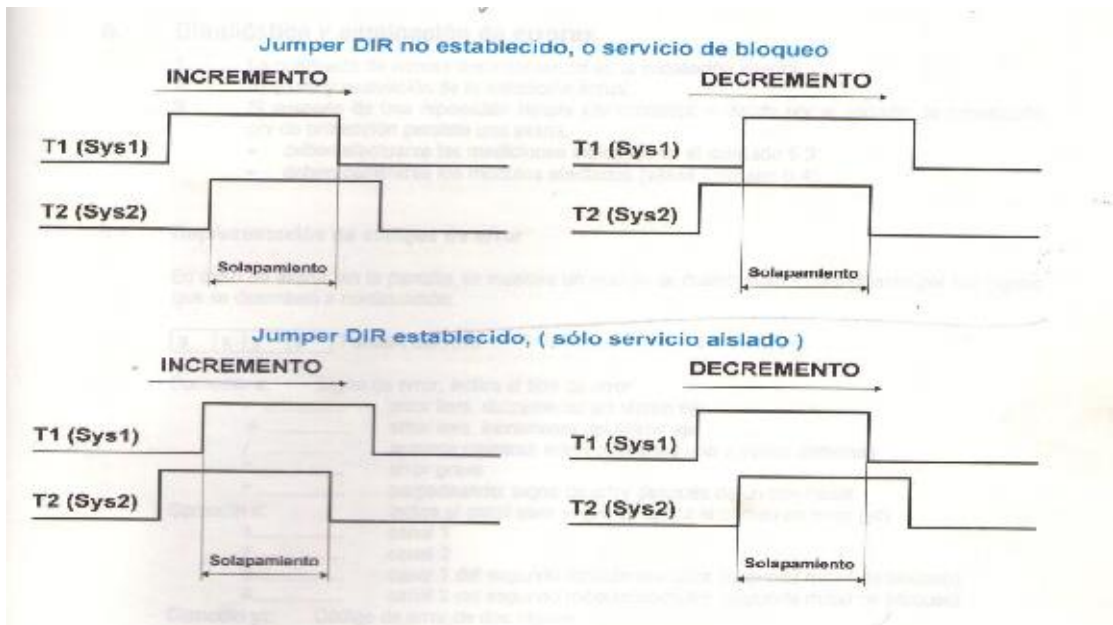
Figura 4. Secuencias de paso de una rueda.
