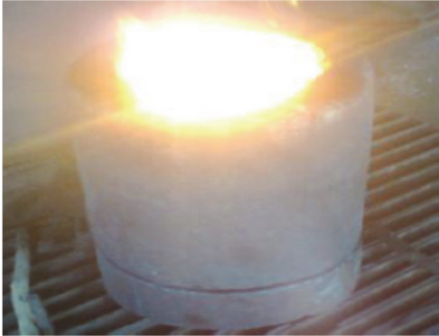
Figura 1: Reactor de grafito durante el procesamiento aluminotérmico
