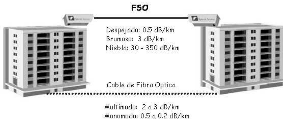
Figura 2.7 Atenuación en sistemas FSO y en Cables de fibra Óptica, Fuente:[48]
