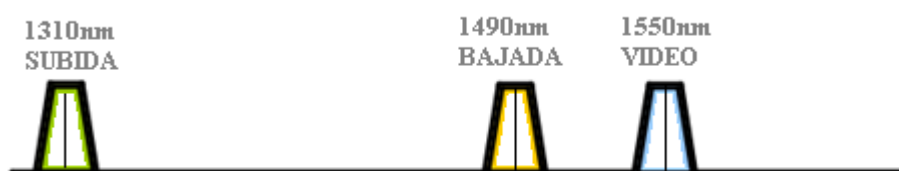
Figura 1.6 Espectro de vídeo overlay. Fuente propia.
