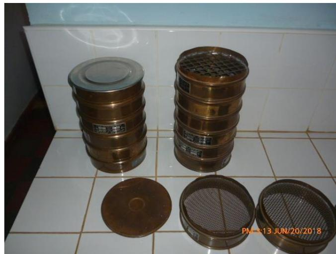
Figura: 2.3 Serie de tamizas de la Norma ASTM c-3 147/92
