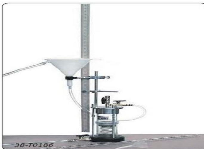
Figura: 2.6. Permeámetro combinado, modelo: k-605 Al
