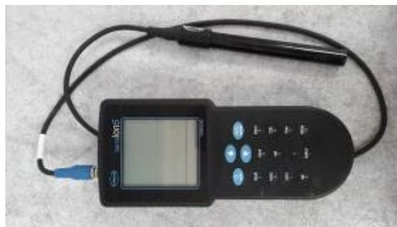
Figura 2.5. Conductímetro, marca HACH, modelo Sension 5.
