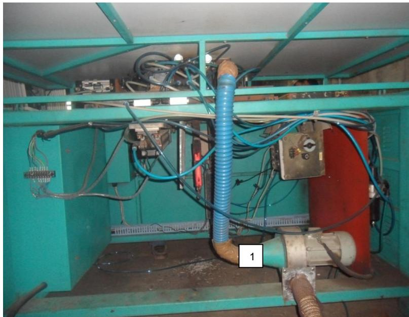
Figura 26: Bomba de extracción de gases
