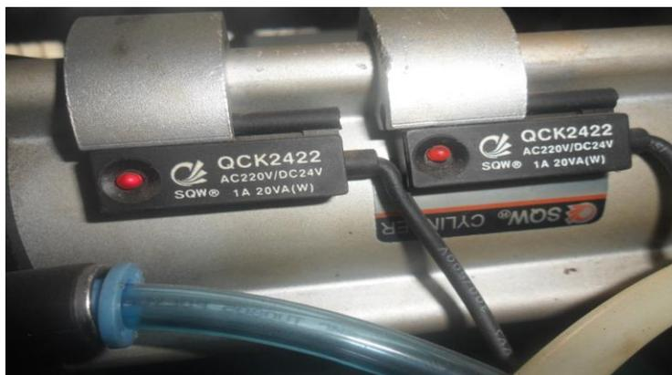
Figura 8: Fotografía del Límite magnético de fin de carrera del pistón
