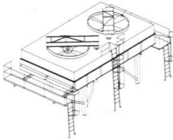
Figura 1. 8 Aerocondensador convección inducida.
