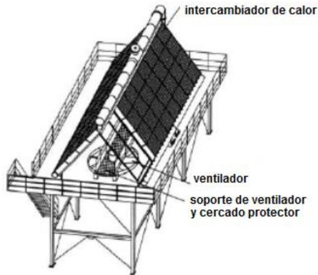
Figura 1. 9 Aerocondensador configuración en "A".
