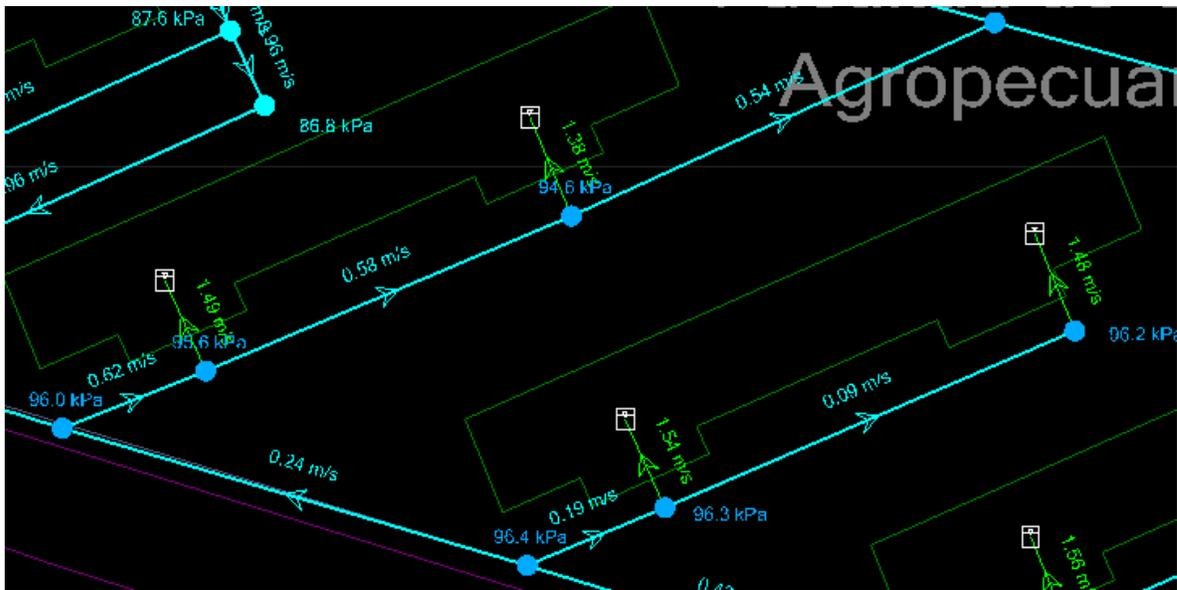
Figura 3.9 Presión en los nodo de la zona de agropecuaria con el sistema sectorizado
