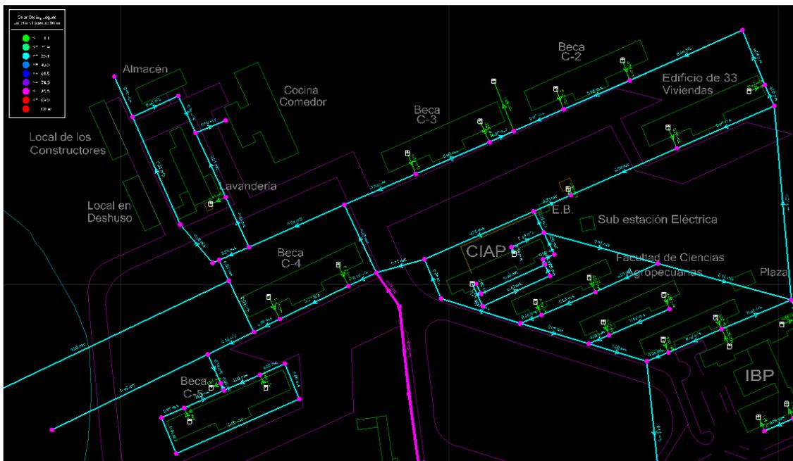
Figura 3.7 Presión no suficiente en los nodos en la zona agropecuaria
