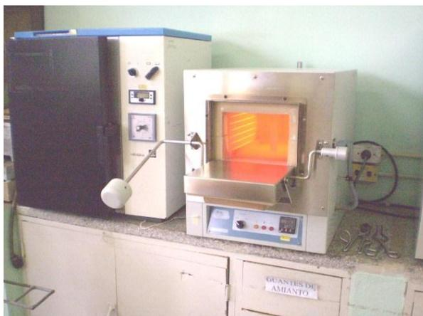
**Figura 2.3 Mufla utilizada para tratamiento térmico**
