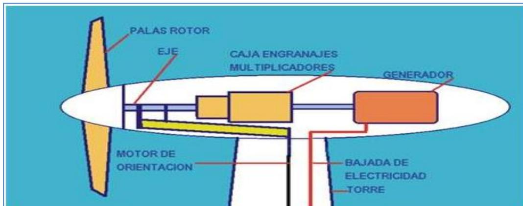
Figura 1.3. Partes de un aerogenerador.
