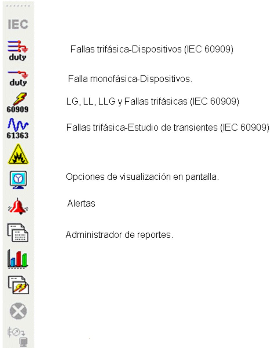
Figura 2.16 Barra de herramientas para el cálculo de cortocircuito según la norma IEC 60909.
