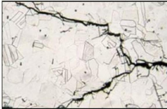
Figura 14. Corrosión por fractura bajo tensión.
