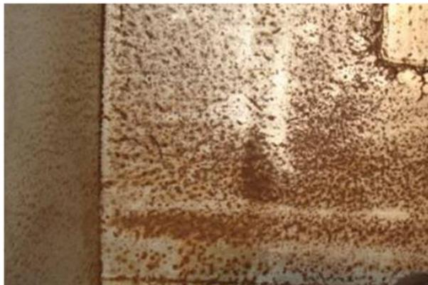
Figura 13. Corrosión por picadura
