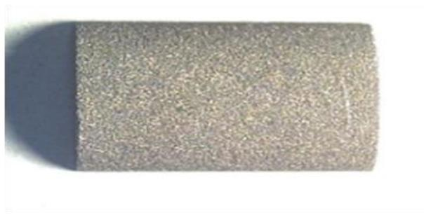
Figura 10. Corrosión generalizada.
