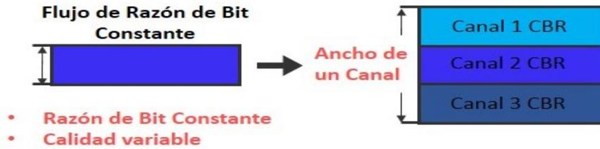
Figura 1.8. Multiplexación tipo CBR. Fuente: Elaboración propia
