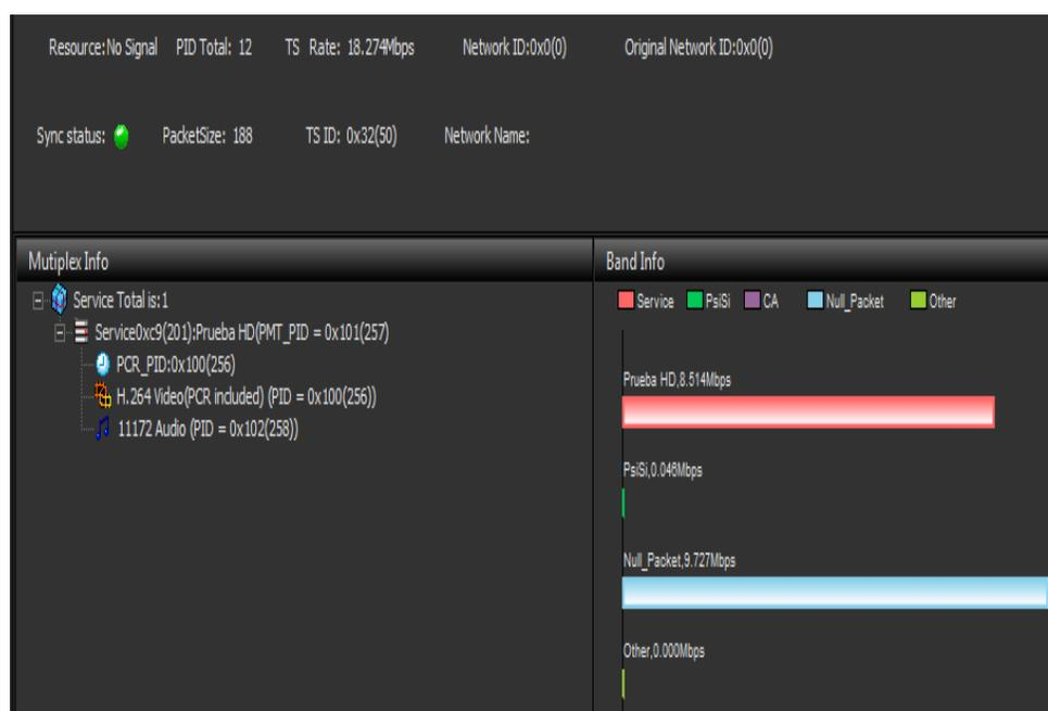
Figura 2.10. Fragmento de una captura del *software* en el módulo *Summary* en medición al canal 32. Fuente: Elaboración propia.
