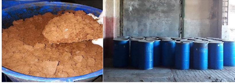
Figura 2.2: Almacenamiento de los residuos galvánicos de la Empresa Industrial de Instalaciones Fijas
