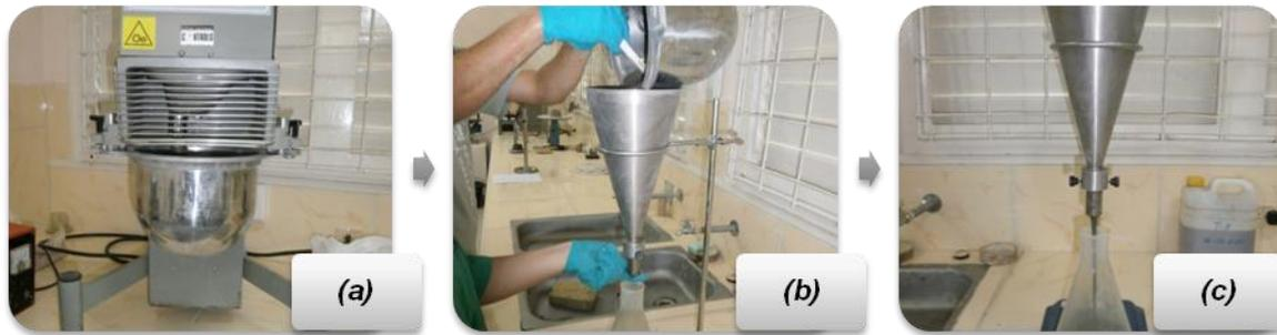
**Figura 2.7** “Procedimiento del Ensayo Embudo de Marsh: a) mezclado de la pasta, b) llenado del embudo y c) mezcla fluyendo a través del orificio del embudo”
