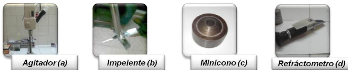
**Figura 2.3** “Equipos v utensilios del método de ensavo del Minicono”
