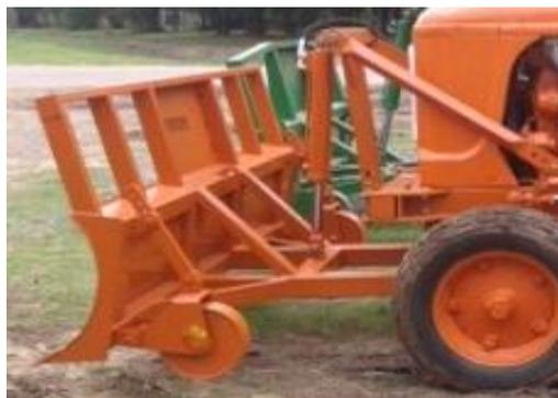
Figura 3.3. Modelo de pala topadora montada sobre tractor, con movimiento oscilante en el plano vertical y rueda de apoyo en la pala.
