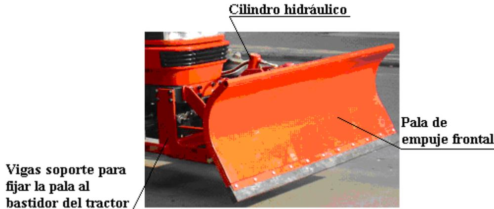
Figura 3.1. Modelo de pala topadora montada sobre tractor, con movimiento oscilante en el plano vertical.
