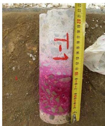
Figura 2.16: Ensayo de profundidad de frente carbonatado con aplicación de fenolftaleína. Fuente: (NC\_355, 2004)
