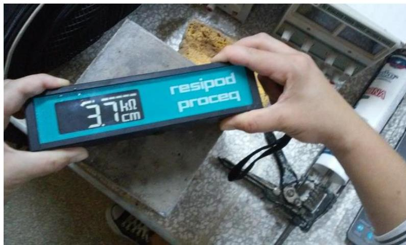
Figura 3.3: Resistividad hormigón con árido reciclado encapsulado.
