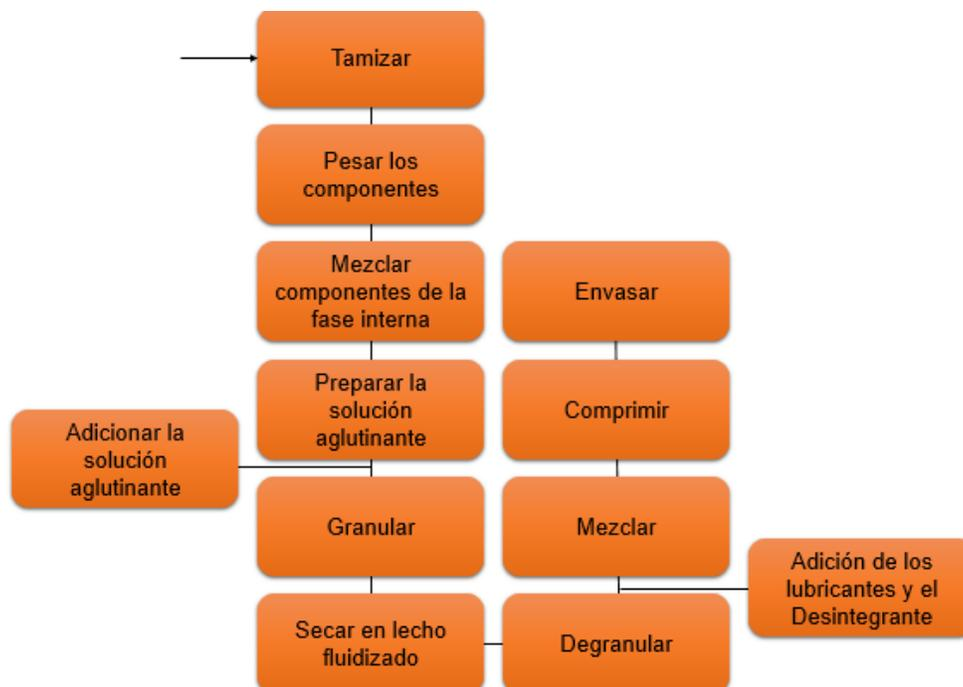
**Figura 2:** Pasos a seguir en la granulación húmeda
