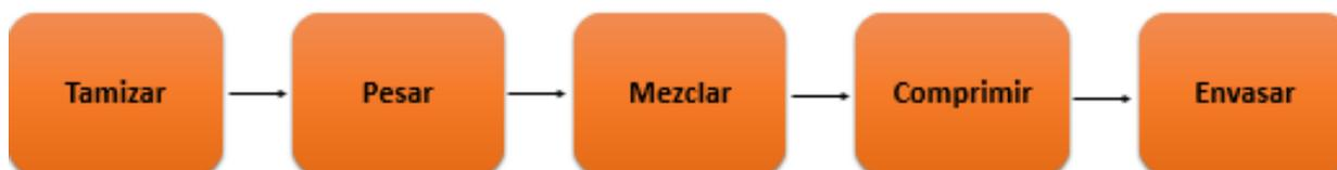
Figura 1: Pasos seguidos en el método de compresión directa
