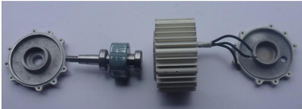
Figura 15 Generador eléctrico
