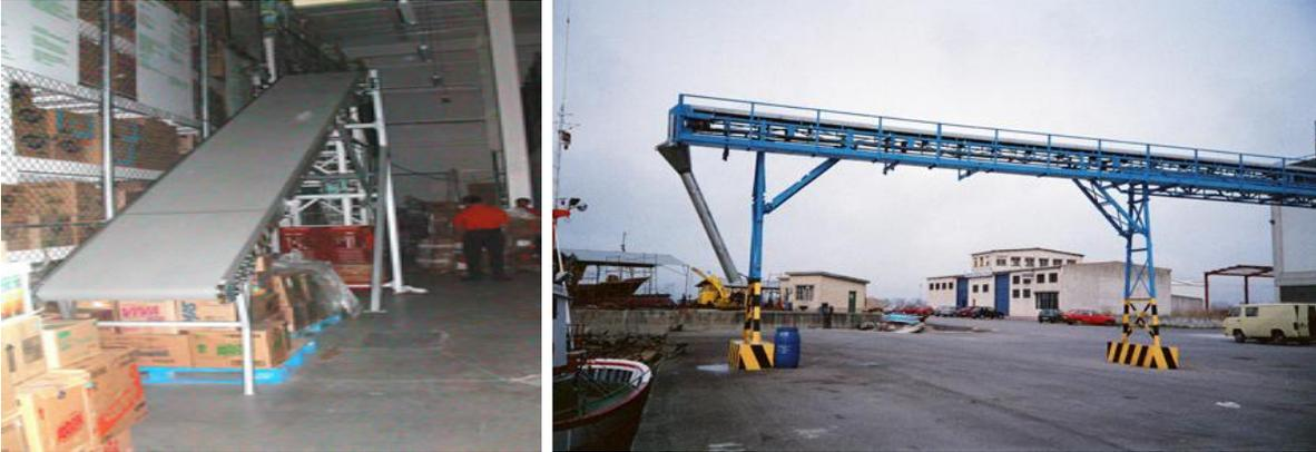
Fig. 1 Diferentes transportadores de banda.
