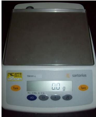
**Figura 3.9.** Balanza marca “Sartorius” utilizada en la medición del peso aplicado
