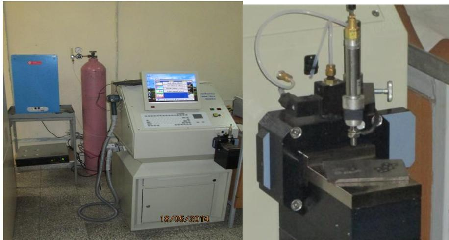
**Figura 3.3.** Máquina utilizada en el análisis químico.
