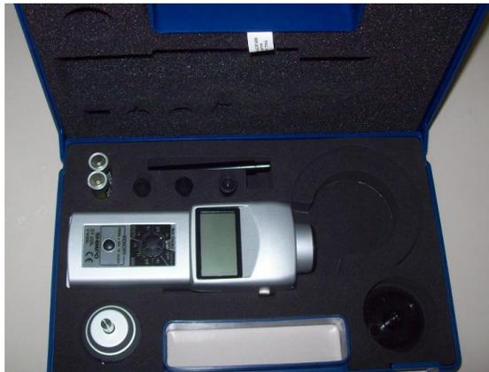
**Figura 3.8.** Tacómetro láser digital marca SHIMPO DT-205L
