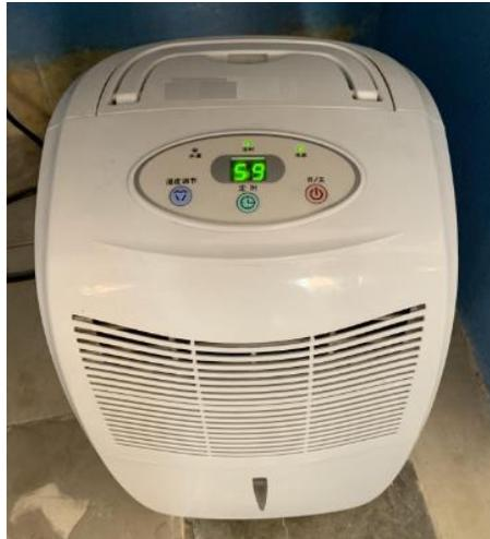
**Figura 3.7.** Control de la humedad relativa con un deshumidificador
