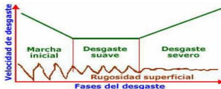
**Figura 1.** Fases del desgaste versus velocidad de desgaste. Fuente [8]
