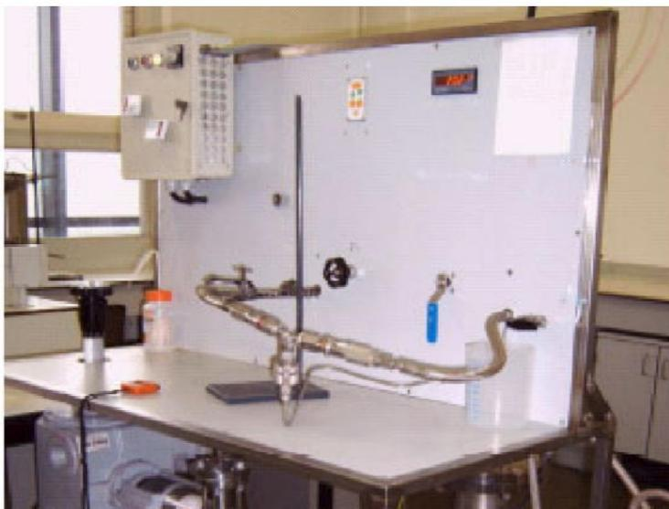
**Figura 1.** Fotografía de la instalación del módulo de filtración de flujo cruzado empleado en la KULeuven.
