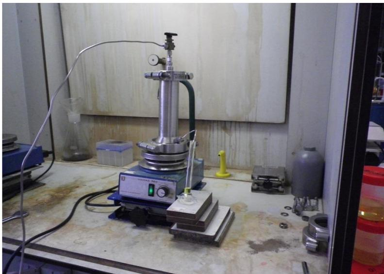
**Figura 1.** Fotografía de la instalación del módulo de filtración de flujo transversal empleado en la KULeuven.
