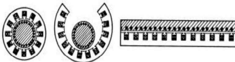
Figura 2.9: Transformación topológica de un motor de inducción rotativo en un motor lineal plano.
