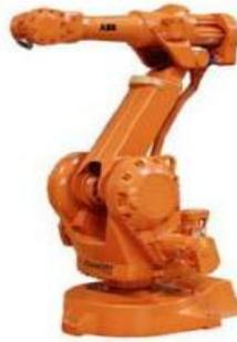
Figura 1.2: Robot tipo serie.
