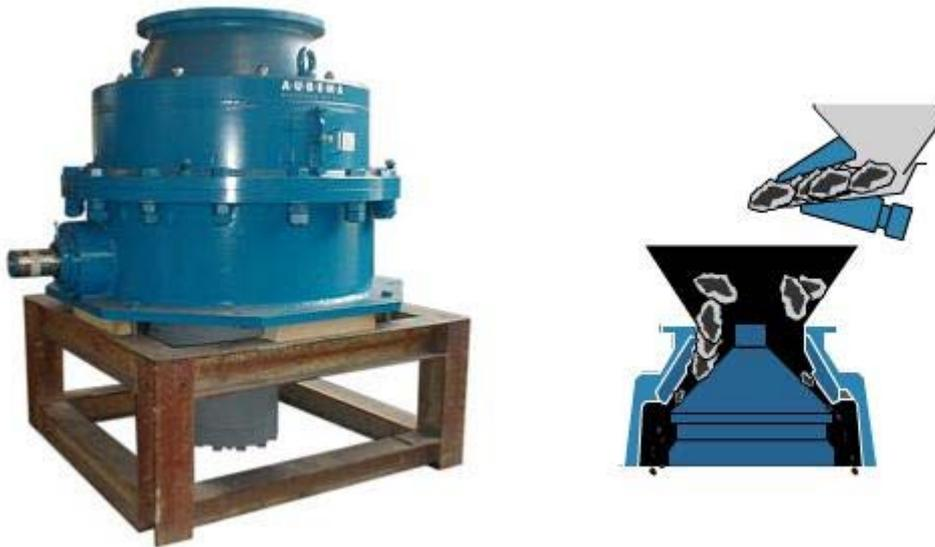
Figura 1.2 Quebrantadora giratoria. (Maquinarias Shibang, 2009).
