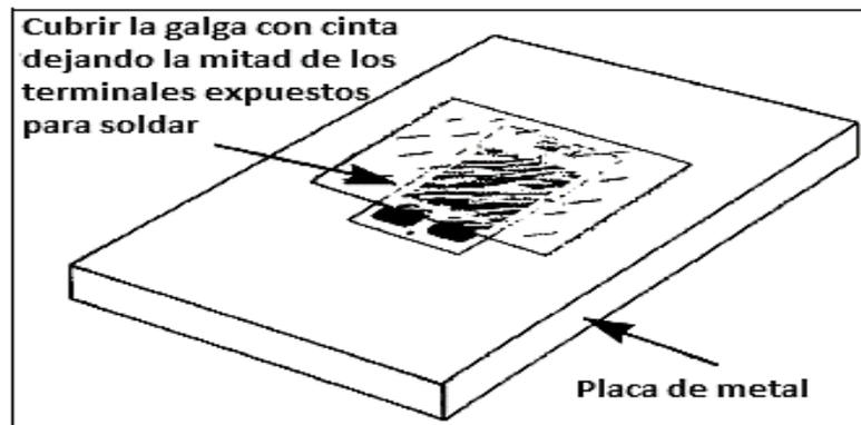
Figura 3.11. Protección del área de la galga y parte superior de los terminales con cinta adhesiva.
