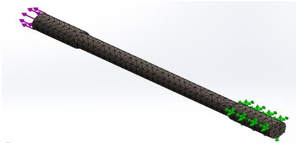
Figura 2.6. Modelo de la probeta
