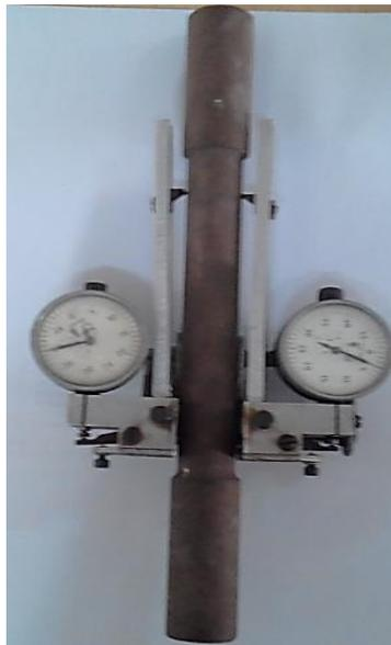
Figura 2.4. Montaje del extensómetro mecánico en la probeta utilizada.
