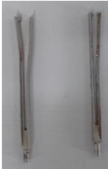
Figura 2.2. Estado de las guías originales del extensómetro.
