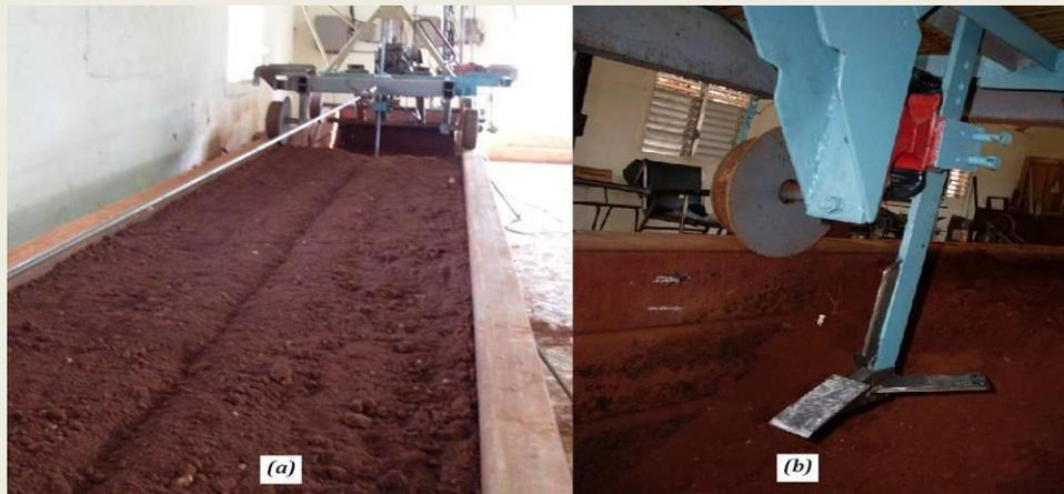
Figura: 2.6. Instalación de la herramienta en el canal de suelo.
