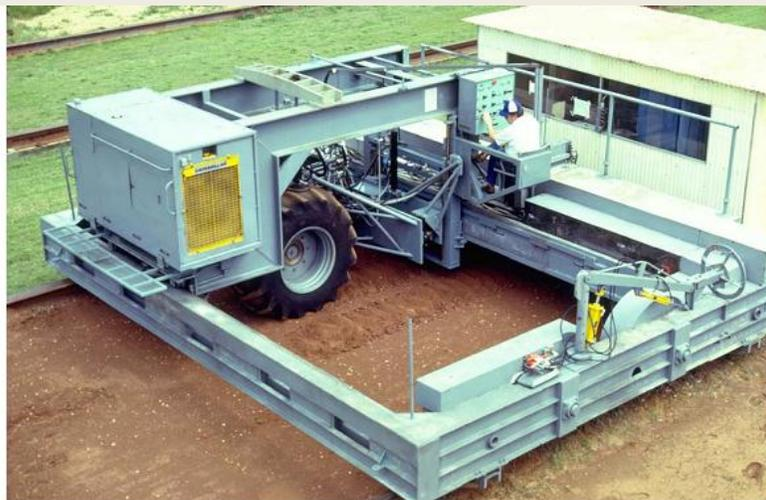
**Figura 1.2.** Instalaciones de un canal de suelo de grandes dimensiones.
