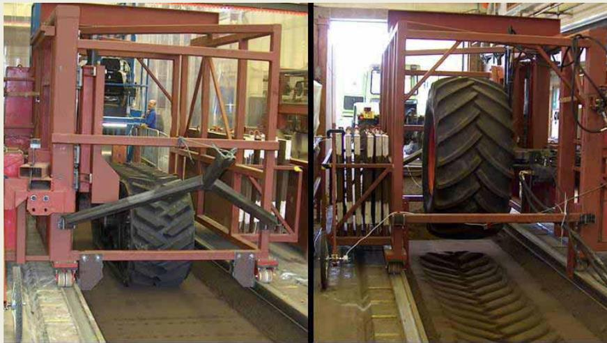
*Figura 1.3# Pruebas de rodamiento de neumáticos en un canal de suelo*
