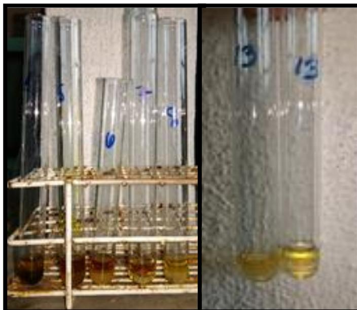
**Fig. 3.6** Ensayo de Böntrager para las fracciones de la fase móvil metanol.
