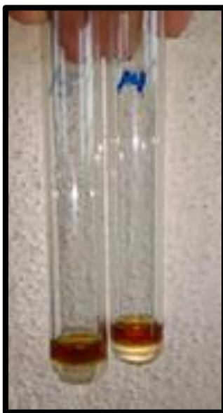
**Fig. 3.8** Ensayo de Börntrager de las fracciones de la fase móvil metanol-agua.
