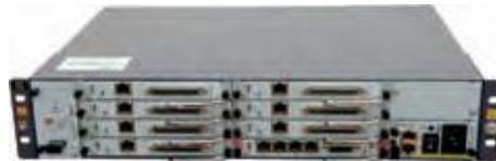
**Figura 6. Dispositivo de acceso integrado IAD 1224. Fuente: Huawei Products.**
