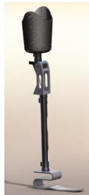
*Figura 2.37 Vista general de la prótesis diseñada (incluye además de la rodilla el pie, la pierna y el encaje)*
