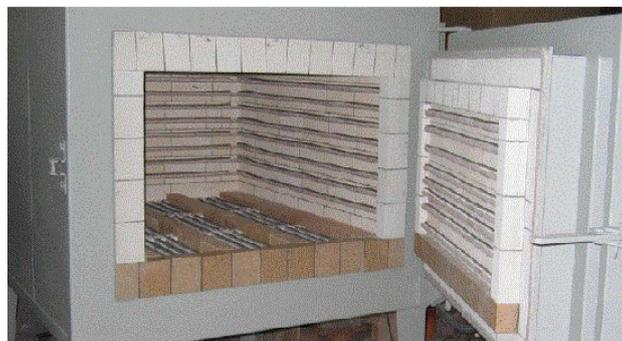
Figura 3. Horno de resistencia eléctrica (Bautermic, 2014)
