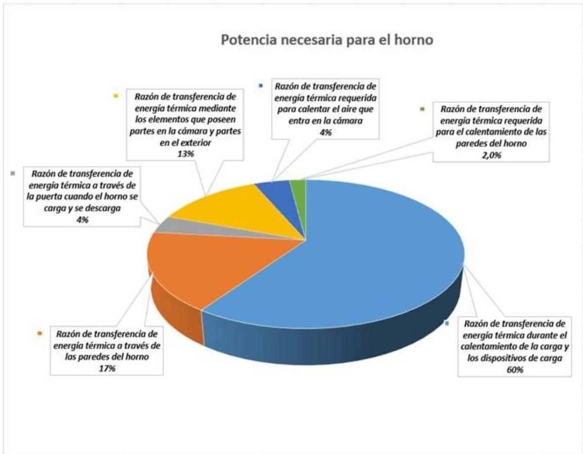
Figura 24. Gráfico de distribución porcentual de los diferentes ítems del balance de energía.
