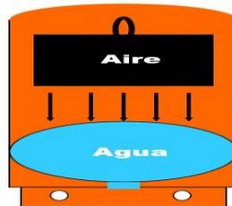
Figura 2.4: Tanque hidroneumático precargado (de membrana).
