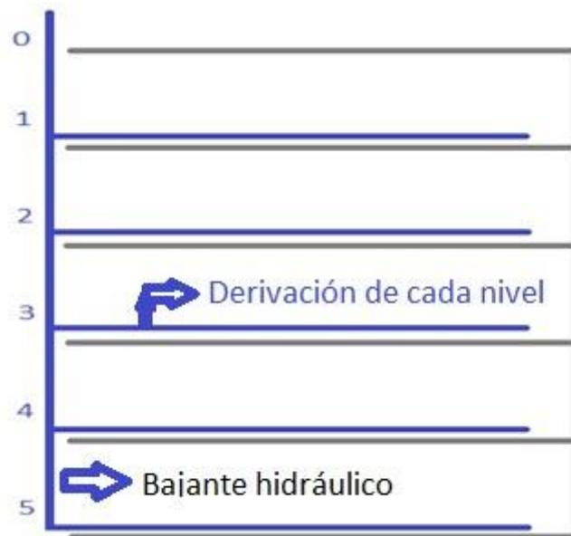
Figura 3.6: Croquis del bajante hidráulico.
