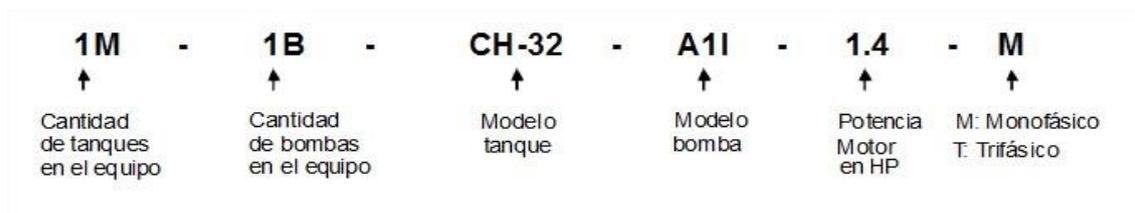
Figura 3.7: Designación de los equipos hidroneumáticos Hidrostat.
