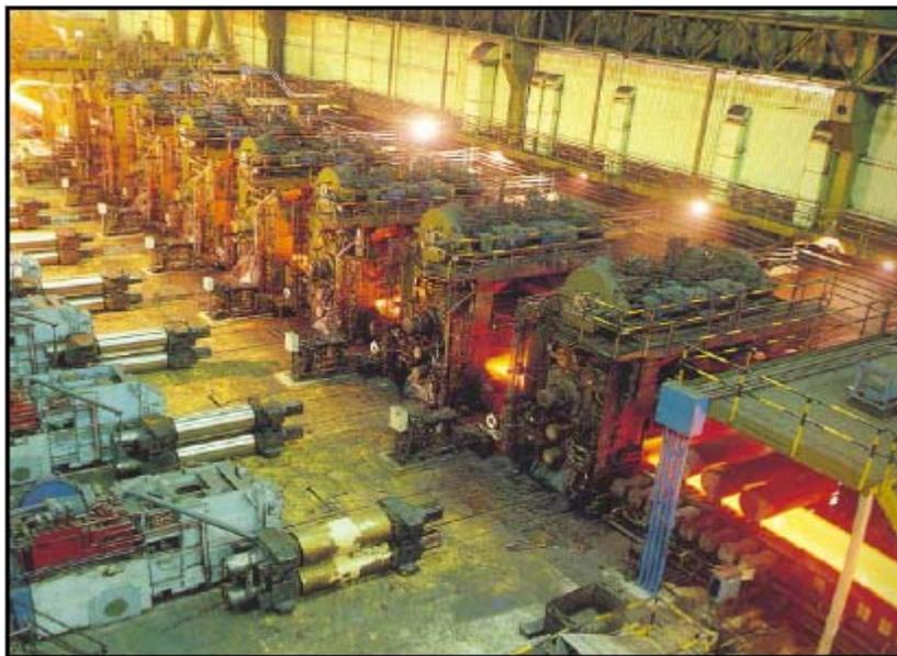
Figura 1.2: Tren de laminación de bandas
