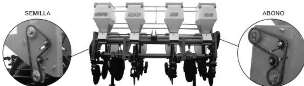
Figura 3.11. Sistema de trasmisión de la sembradora fertilizadora JUMIL “POP JM2570PD SH-MG”.
