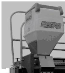
Figura 3.8. Depósito de abono de la máquina sembradora fertilizadora JUMIL “POP JM2570PD SH-MG”.
