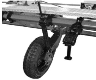
Figura 3.10. Rueda motriz con su sistema pivotante.
