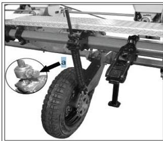
Figura 3.29. Regulación de la presión de las ruedas motrices sobre el suelo.
