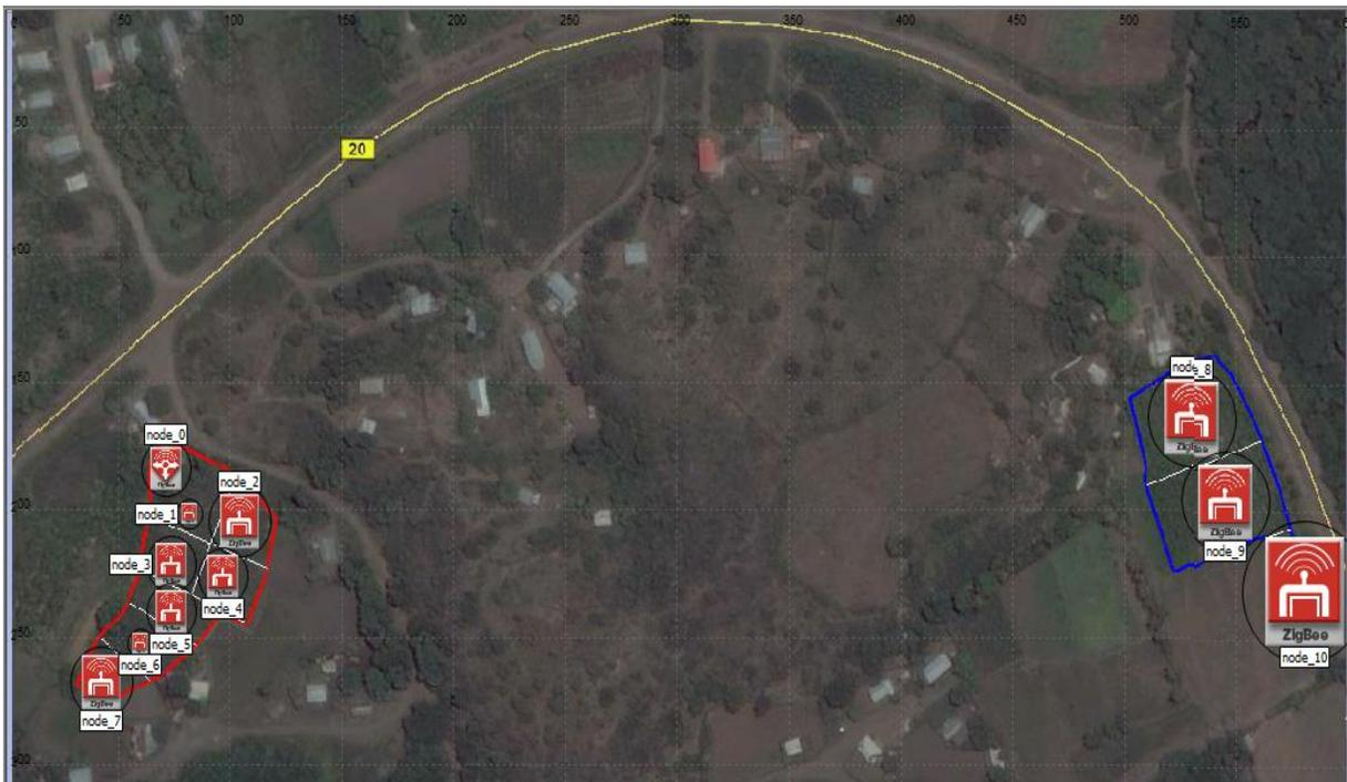
Figura 3.1: Ubicación de los dispositivos ZigBee. Imagen de OPNET Modeler 14.5 y Google Earth.
