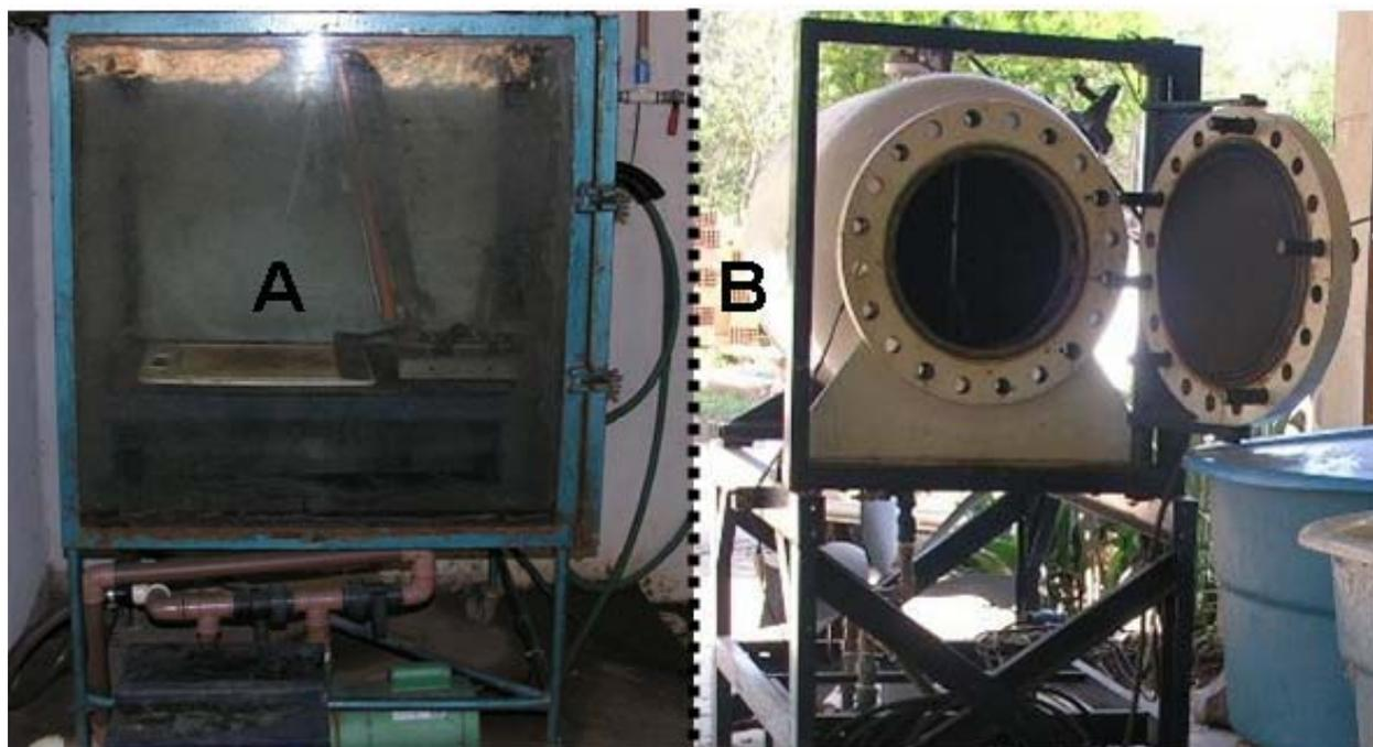
**Figura. 2** Equipamiento empleado para la realización de los depósitos de soldadura, A: Acuario con el dispositivo de soldadura por gravedad, B: Tanque presurizado.
