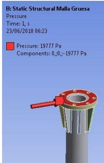
**Figura 3.1** Carga del viento sobre el aerogenerador.
