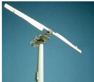
**Figura 1.7** Aerogenerador horizontal bipala
