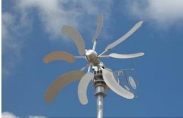
**Figura 1.9** Aerogenerador horizontal multipala
