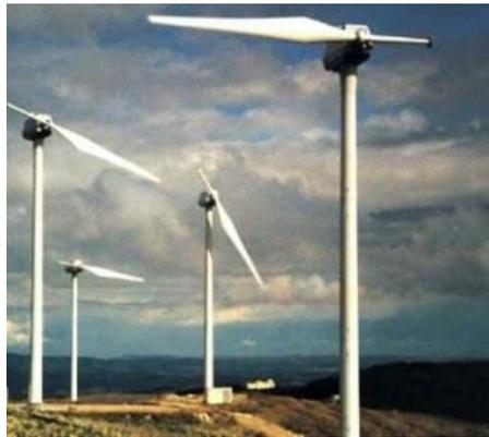
**Figura 1.6** Aerogenerador horizontal monopala
