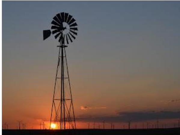
**Figura 1.4** Aerogenerador americano multipala, usado en el abasto de agua.
