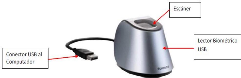
Figura 2.18: Conexión USB del Lector Biométrico a la PC
