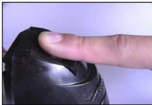
La forma correcta de ubicar el dedo sobre el escáner es de manera firme sobre el mismo, centrado en el área del escáner y sin girar el dedo.
