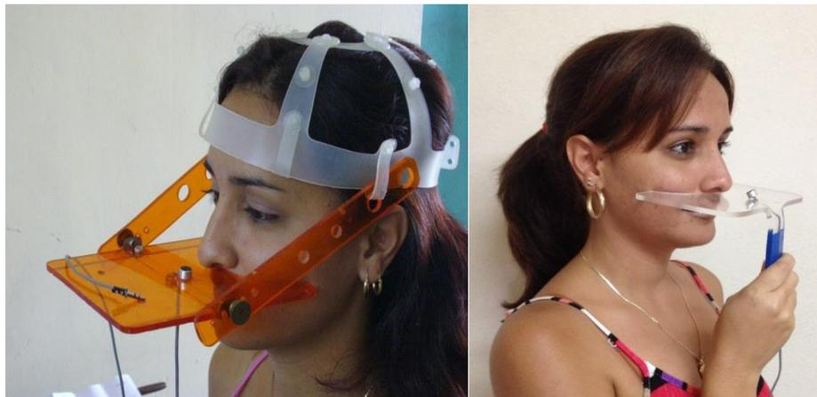
Figura 2.2: Nasómetros con soporte de cabeza y con soporte manual respectivamente.
