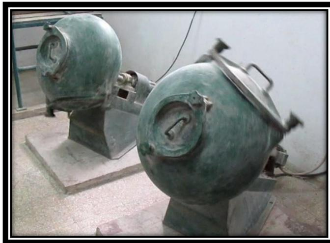
Figura3. Molinos utilizados a escala de laboratorio.
