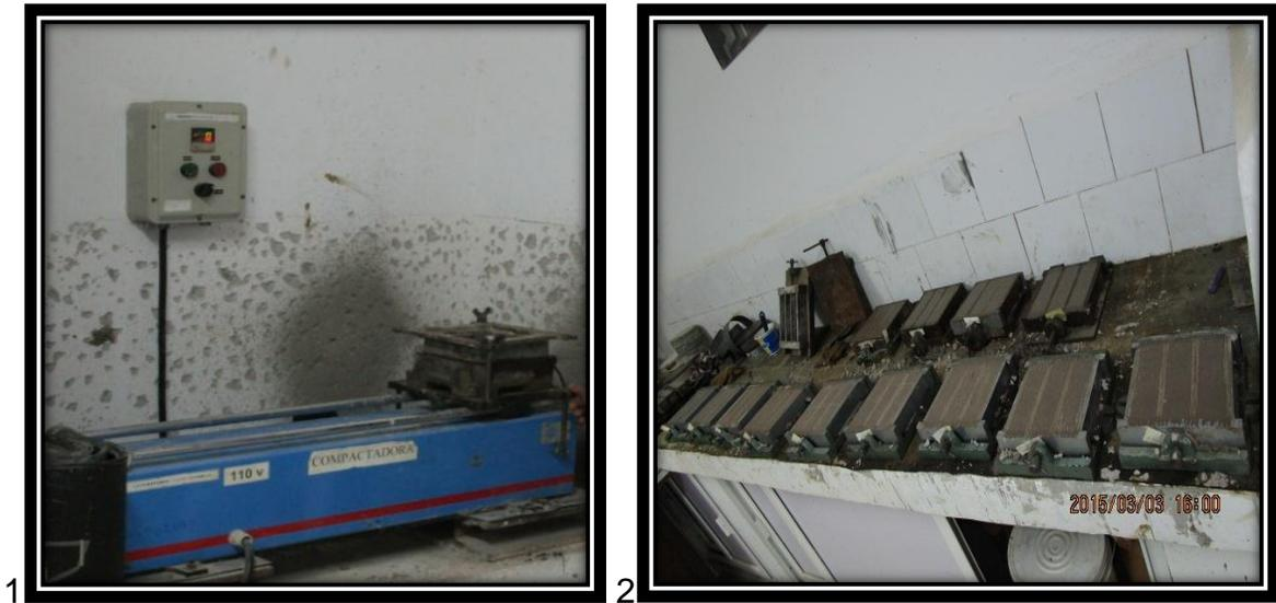
Figura 7 1) Equipo de compactación 2) Llenado de moldes prismáticos de morteros
