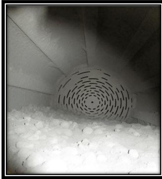
Figura 9 Primera cámara del molino con material acumulado
