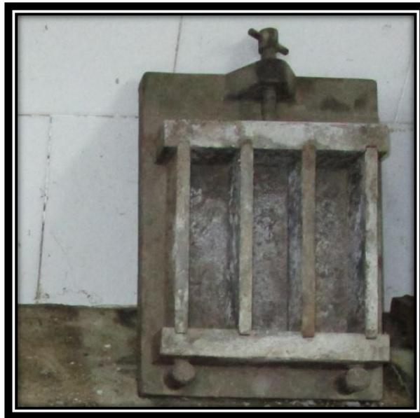
Figura 5 Molde empleado para la elaboración de los morteros
