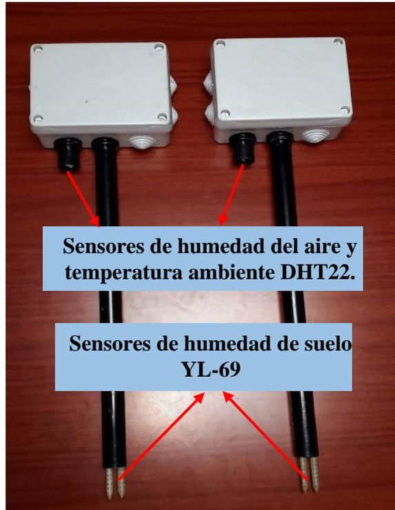
Fig. A.8 – Nodos sensores desarrollados encapsulados, donde se observan la posición de los sensores incorporados (Fuente: Autor).
