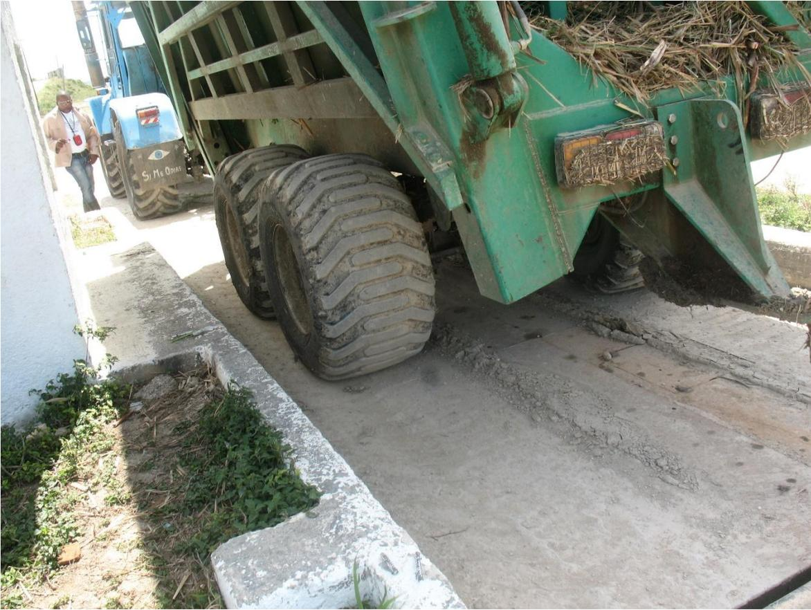
Figura 3. Determinación del peso del remolque.
