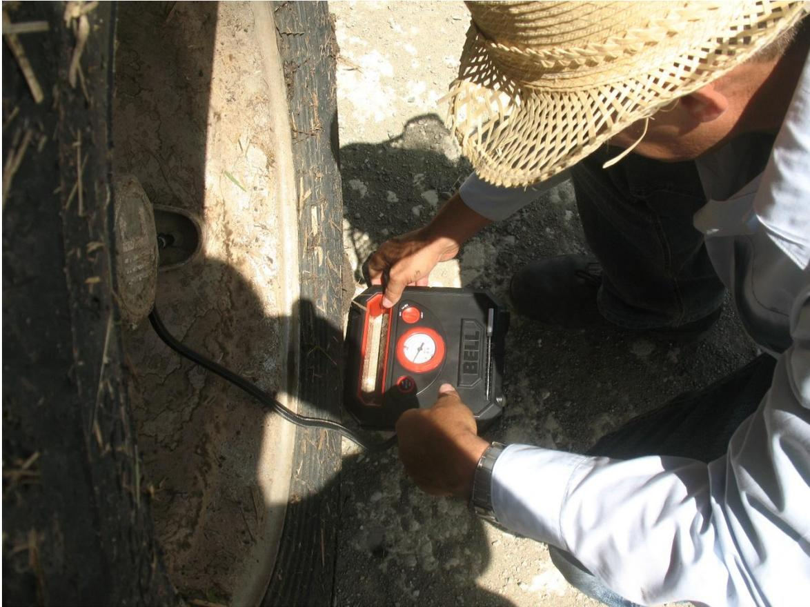
Figura 5. Medio para determinar la presión de inflado.
