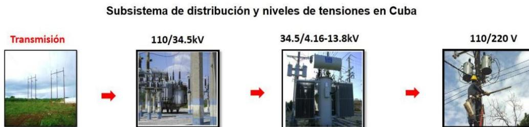
*Figura 1: Diagrama del subsistema de distribución de energía eléctrica en Cuba.*
