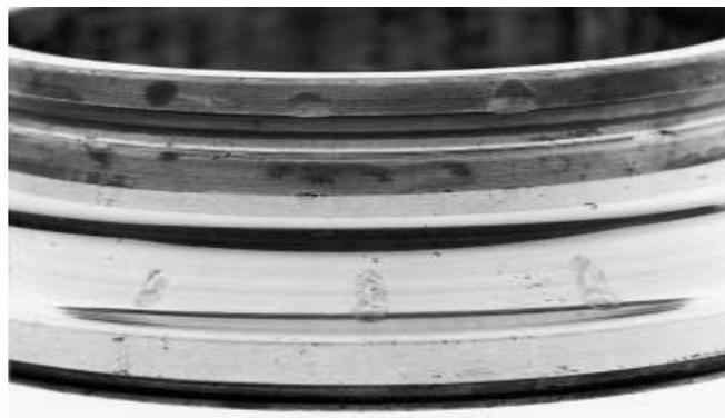
**Figura 2.5 Falso Brinelling en un rodamiento de bolas.**
