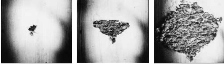
**Figura 1.3 Evolución de falla por fatiga producto a rodadura sobre cuerpos extraños.**
