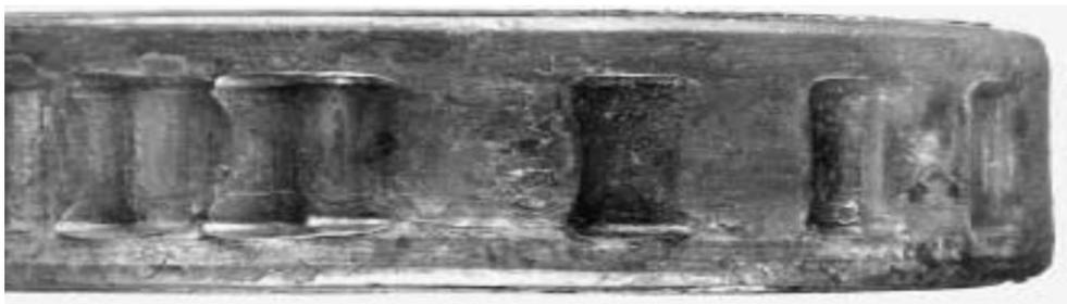
**Figura 1.10 Bloqueo de un rodamiento de rodillos cilíndricos producto a un sobre calentamiento por fricción.**
