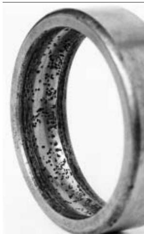
**Figura 1.8 Oxidación en el aro exterior de un rodamiento rígido de bolas.**
