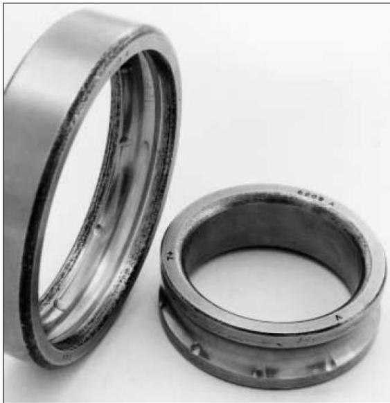
**Figura 1.4 Indentaciones producidas por las bolas en un rodamiento rígido de bolas.**
