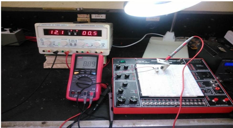
Figura 3.3 Circuito real con fuente, multímetro y Breadboard
