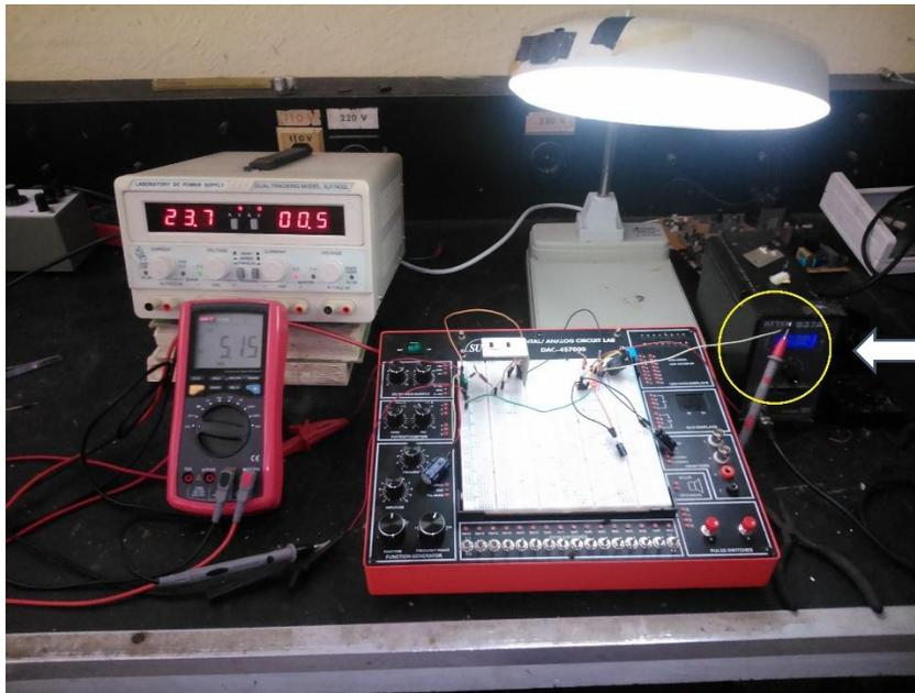
Figura 3.9 Medición del terminal de 5V en la fuente
