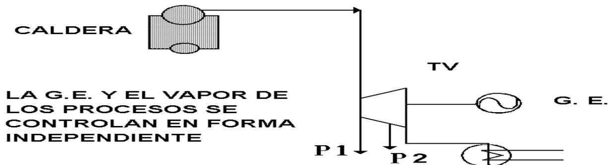
Figura 1.5- Esquema con turbina de extracción condensación [4].
