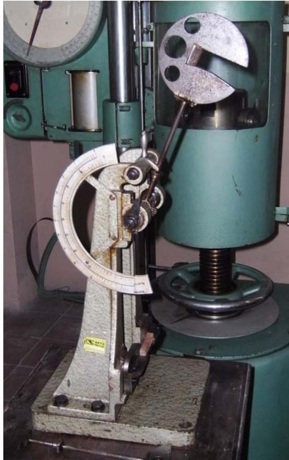
Figura 17: Máquina de ensayo Charpy
