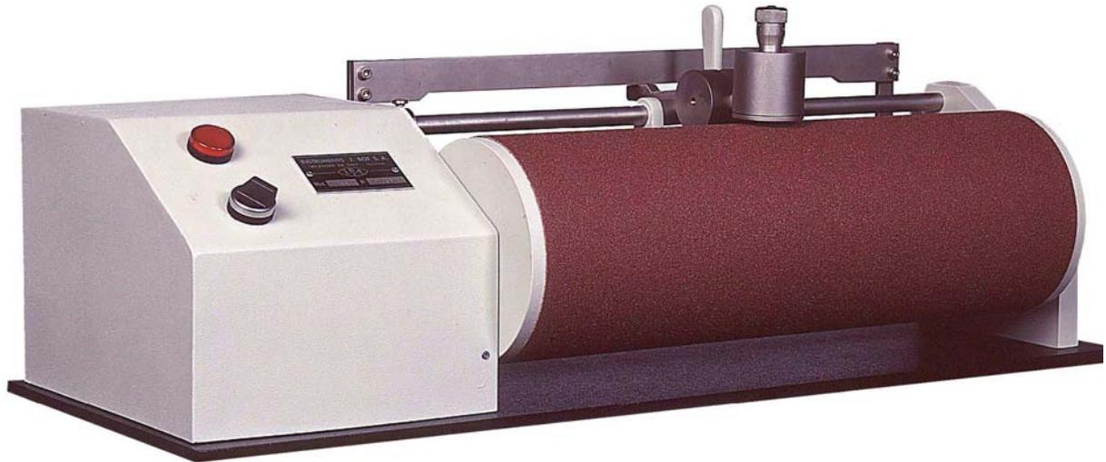
Figura 10: Ensayo de abrasión en ELASTOMEROS. Abrasímetro mod. 655.
