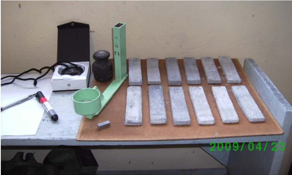
*Figura 15: Equipamiento para el ensayo de abrasividad*
