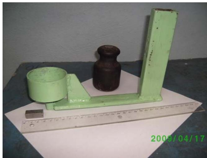
Figura 14: Dispositivo de abrasividad
