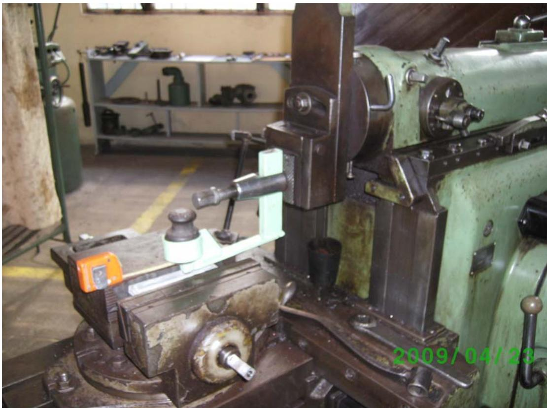
*Figura 16: Máquina para ensayo de abrasividad*
