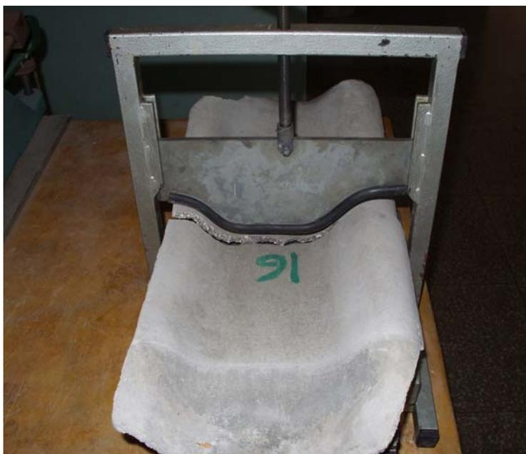
**Figura 4.3. Ensayo de Flexión.**
