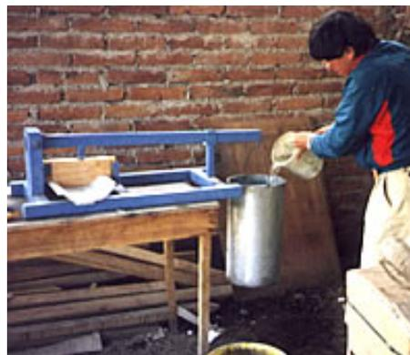
Normalmente el ensayo se realiza con la teja secada al ambiente, no obstante el ensayo garantiza una mayor precisión cuando utiliza las tejas húmedas, previamente sumergidas en agua durante 24
