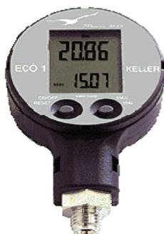
**Figura 3.2** Manómetro digital ECO. **Fuente:**(AbCo, 2014)
