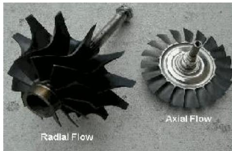
**Figura 1.5** Turbina a la derecha de flujo axial y a la izquierda de flujo radial. **Fuente:**
