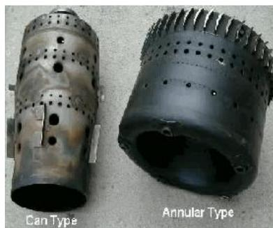
**Figura 1.4** Cámaras de combustión a la izquierda de tipo barril y a la derecha de tipo anular. **Fuente:** (Mataix, 2000)
