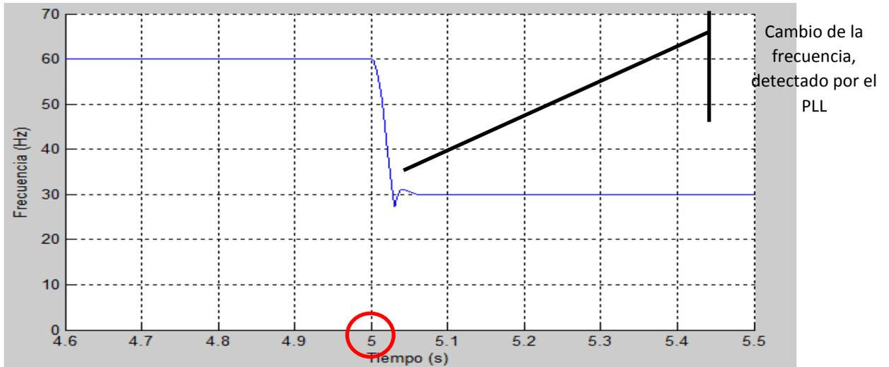
Figura 3.3 Frecuencia muestreada por el PLL.
