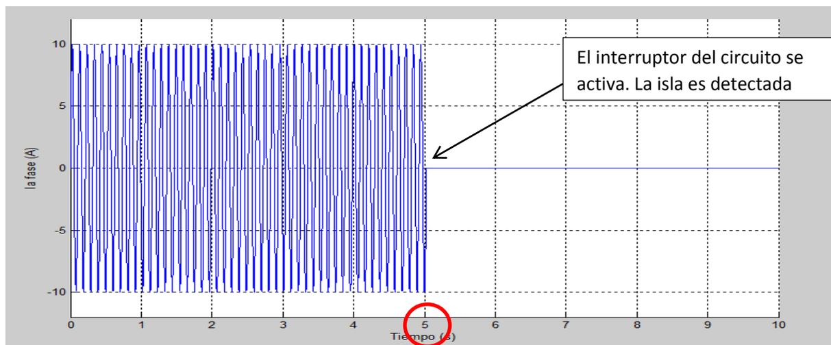
Figura 3.10  $I_a$  de fase del generador.
