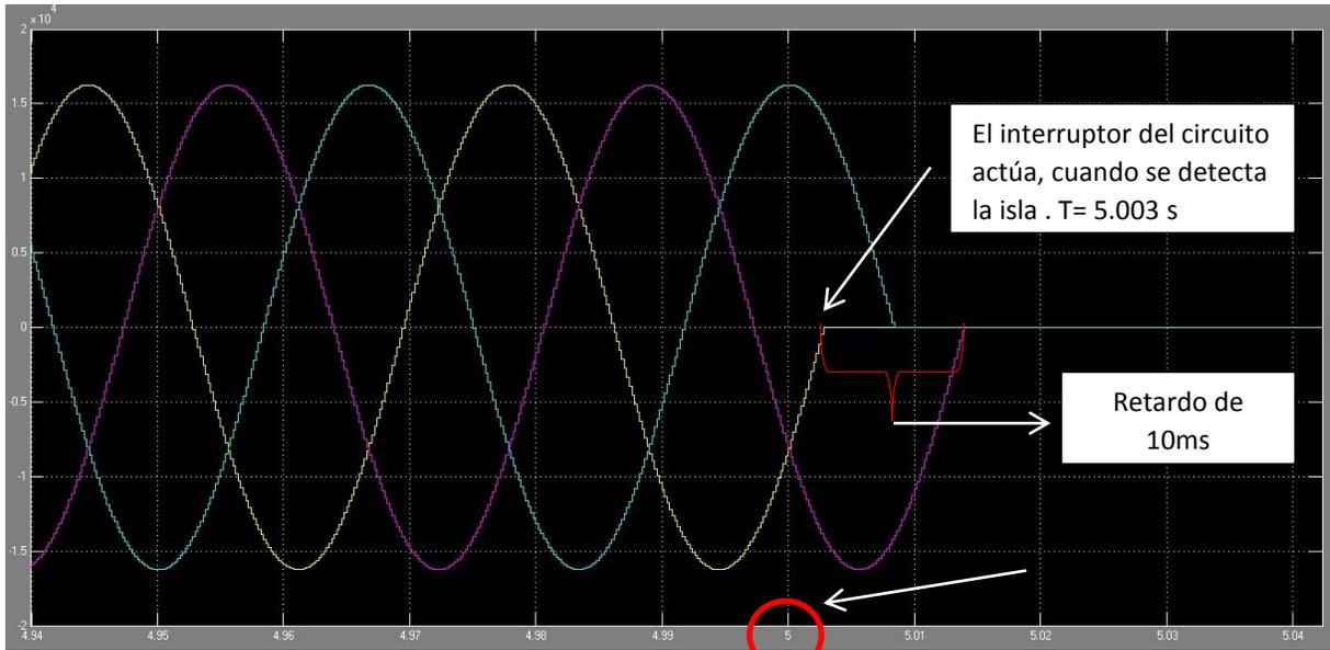
Figura 3.7 Voltaje del generador.
