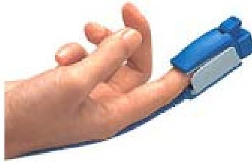
**Figura 1.4 Sensor óptico para fotopleletismografía situado en el dedo índice.**
