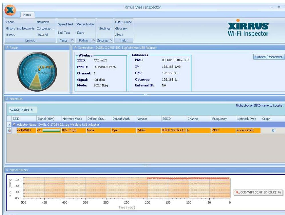
Figura 2.5. Xirrus WiFi Inspector. Software del tipo “Site Survey Tool”.
